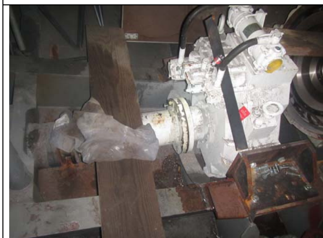
Kopče su odvojene od motora
