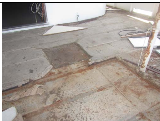
Krmeni dio gornje palube je izrezan pa opet zavaren
