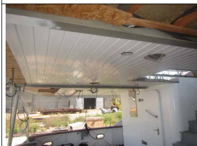
Stropne obloge su postavljene većim dijelom
