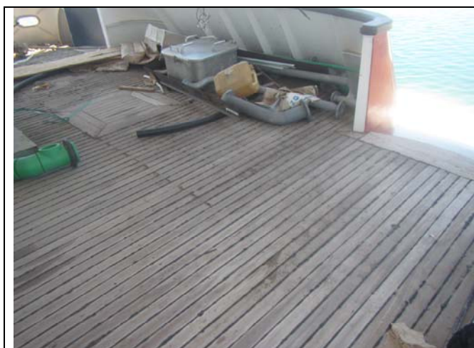
Na krmenom dijelu glavne palube sljubnice nisu završene
