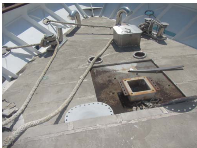
Oprema za privez na pramčanoj palubi
