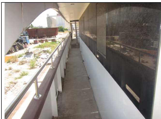
Prolazi gornje palube su spremni za postavu drvene obloge. Razme imaju drvene poklopnice i ograde.
